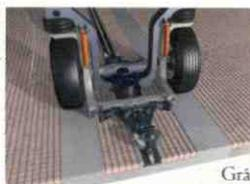
Grâce à une charge à l'essieu faible (7 t) et une pression minimale au sol dans les pneumatiques (6 bar), TRANSLOHR permet l'installation de chaussées modestes, limitant les temps de chantier et les travaux de génie civil. Grâce à des plateformes optimisées (longrines béton, tengoser etc...) toutes les solutions esthétiques sont proposées : finitions pavés, gazon, revêtements granitiques, colorés etc...
